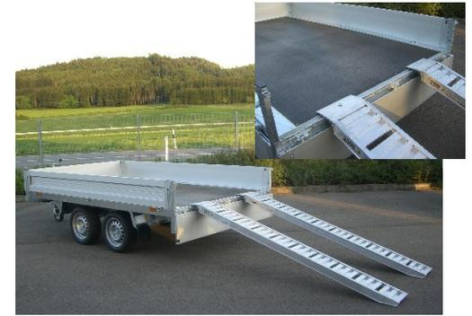
Alu-Rampen mit Abrutschsicherung
