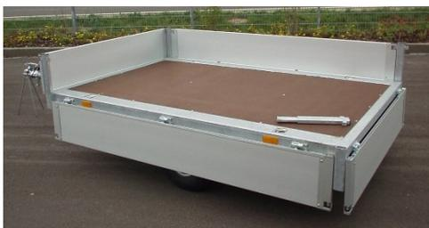
Steckbare Eckrungen 4 mm, Siebdruckboden
