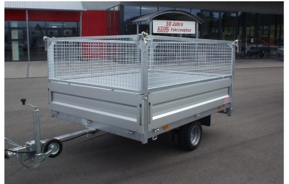
stabiler Maschengitteraufsatz, verzinkt mit soliden Pendelverschlüssen
